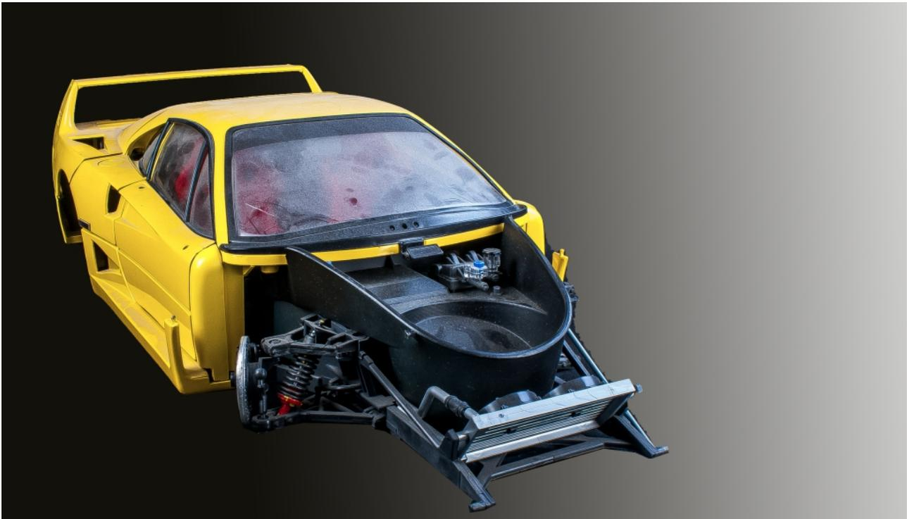
Erste Prototypen der neuen Eigenbau-Metall-Stossdämpfer sowie umgebauter Vorderradaufhängung. Alles voll funktionsfähig.
